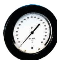
Manómetro de calibración de 6" precisión 0.25% (Grade 3A) con espejo paralelaje
