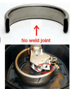
Bourdon de una pieza sin costuras y rueda dentada de transmisión
